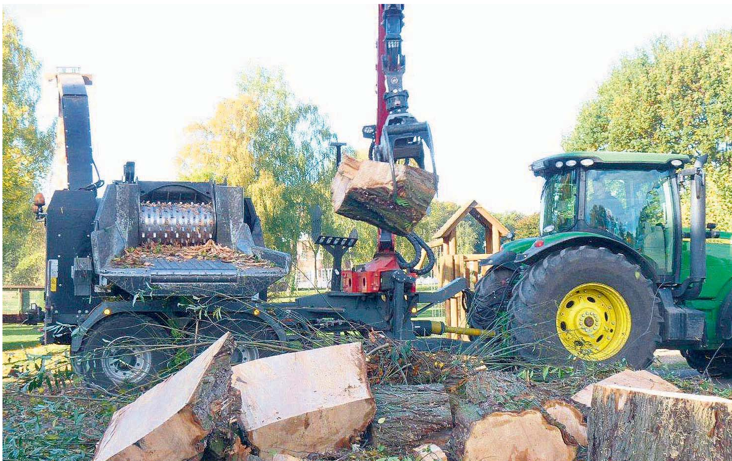
Bildunterschrift: Auch mit großen Brocken wird die Schredderwalze problemlos fertig.
